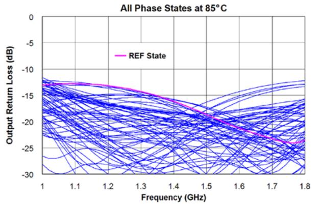
**ПРИМЕЧАНИЕ** Входная мощность при измерениях –5 дБм.
