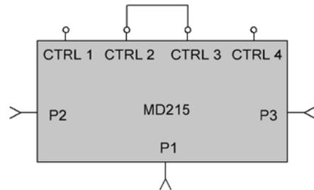
Вариант 2. С подключением интегрированного токозадающего резистора R = 60 Ом.
