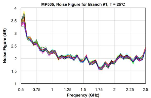
**ПРИМЕЧАНИЕ** Все характеристики устройства соответствуют режиму передачи для ответвления N°1 и режиму изоляции для ответвления N°2.
