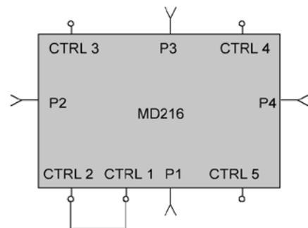
Вариант 2. С подключением интегрированного токозадающего резистора R = 60 Ом.
