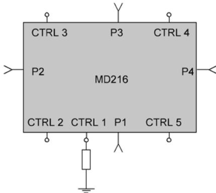
Вариант 1. С подключением внешнего токозадающего резистора.
