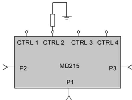
Вариант 1. С подключением внешнего токозадающего резистора.
