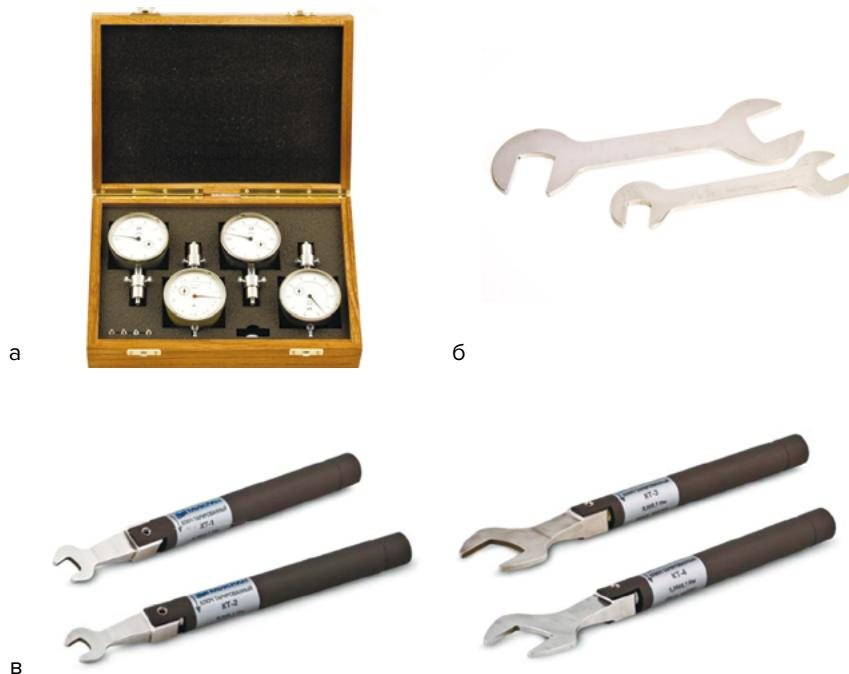
Рис. 44. Набор измерителей присоединительных размеров (а), поддерживающие (б) и тарированные ключи (в)
