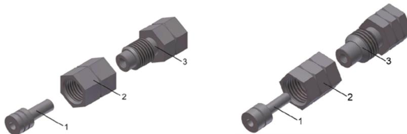
Рис. 10. Приспособление для монтажа блочных резьбовых соединителей типа розетка в тракте 2,92/1,27 мм (ЖНКЮ.296371.030-02).
