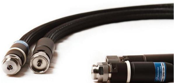
**Для повышения фазовой стабильности кабельные СВЧ сборки изготовлены со специальной защитой и соединителями усиленного типа NMD.** Защита ограничивает минимальный радиус сгиба кабеля, защищает кабель от сдавливания, продольных нагрузок и поперечного скручивания, что повышает ресурс кабеля до нескольких сотен тысяч сгибаний со стабильной фазовой характеристикой.
