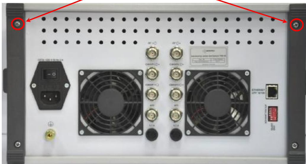
Рисунок 2– Схема пломбировки от несанкционированного доступа
