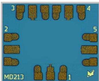
MD213 – монолитная интегральная схема SP4T коммутатора отражающего типа, изготовленная на основе технологии AlGaAs / GaAs pin диодов.
